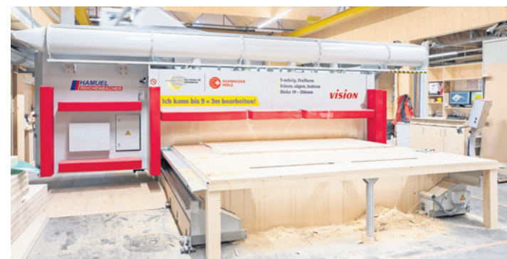
Sie kann Platten mit einer Fläche von bis zu 9×3 Metern und einer Dicke von 19 bis 280 mm bearbeiten: die neue CNC-Anlage Reichenbacher vom Typ «Vision III».
